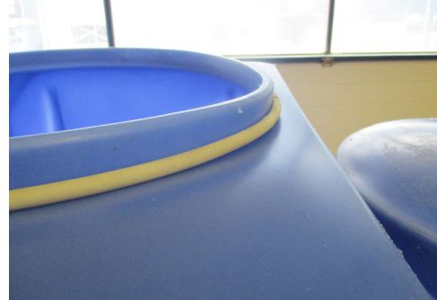
Schritt 2: Rundschnurdichtung \varnothing 14\text{mm} über Tanköffnung stecken
