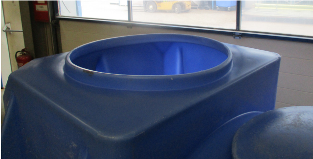
Schritt 1: Domschacht und Abdeckung aus Tank entfernen
